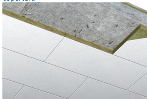
Figura 8.4 – Esempio di isolamento del solaio di copertura
