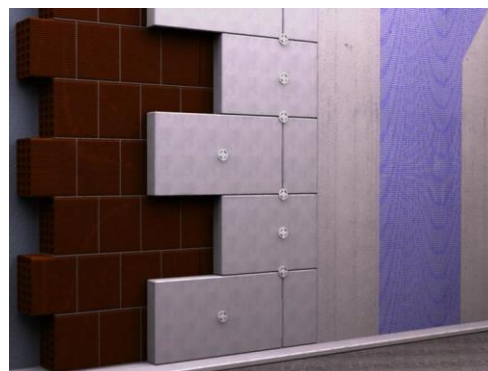
Figura 8.3 – Esempio tipo di coibentazione a cappotto
